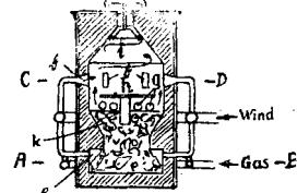
**Henri Louis Adam Cognet, Paris. Elektrischer Ofen mit aus Blechkörpern gebildeten Zellen, die zur Leitung der erwärmten Luft dienen,** 1. dad. gek., daß jede zweite Zelle mit einem die Wärme aufspeichernden Stoff ausgefüllt ist und die zwischen ihnen liegenden Zellen zur Leitung der durch
